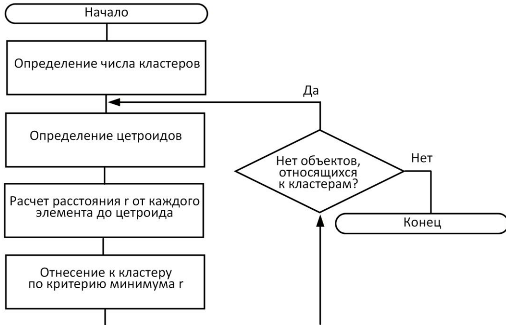
Рис. 2.8 Обобщенная схема алгоритма кластеризации методом К-средних
