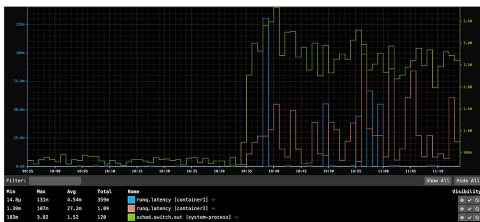
Рис. 1.20 Пример возникновения проблемы «шумные соседи» при выполнении двух контейнеров, развернутых в ВЦОД «Titus». А) Нормальная производительность контейнера container1 , Б) Снижение производительности контейнера container1 за счет захвата ресурса времени процессора контейнером container2
