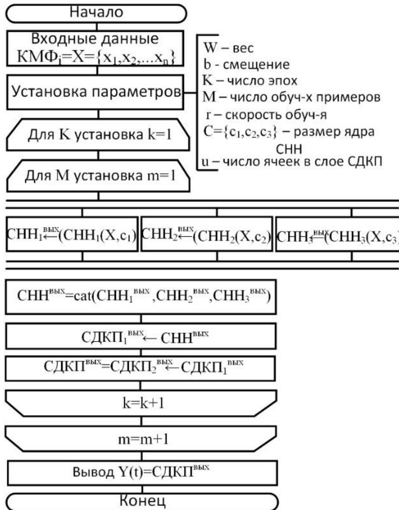
Рисунок 7 – Схема гибридного алгоритма прогнозирования рабочей нагрузки
